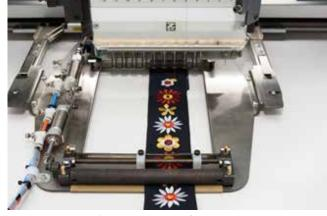
Fig.: Automatic Clamping Frame of ROLL2BASKET
