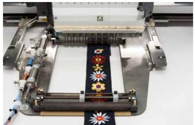
Fig.: Automatic Clamping Frame of ROLL2BASKET
