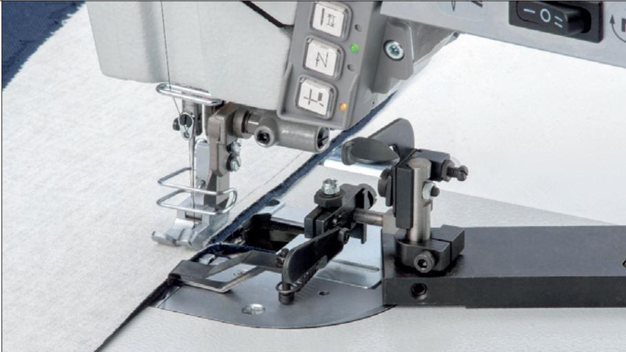
**272-740642-01 mit Nadeltransport und Kantenschneider**
