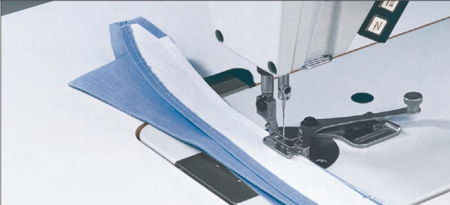
**272-140342-01 – verschiebungsfreie Nähte** durch Nadeltransport – auch in transportkritischen Materialien.
