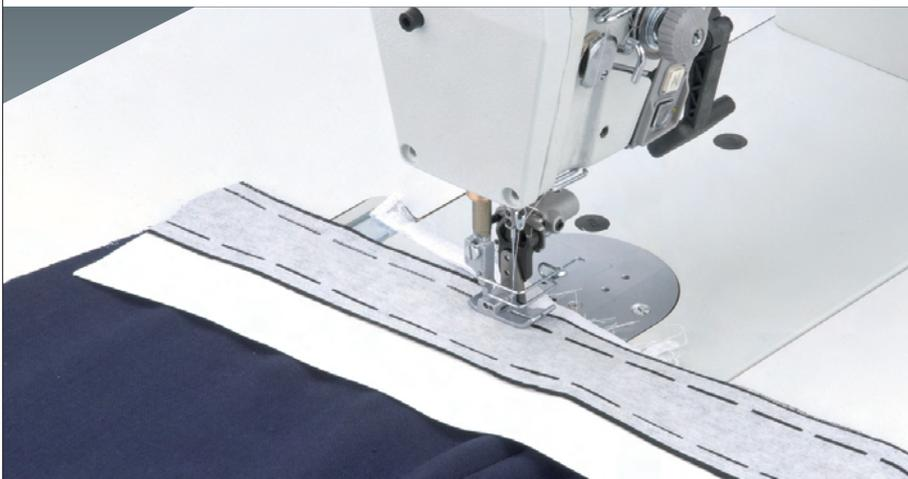
**272-640642-01 mit Nadeltransport und Kantenschneider**
