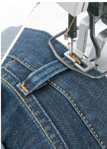
**Riegelarbeiten in mittelschweren bis schweren Materialien:**
