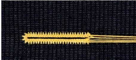
**581-121 E1201 / 581-151 E1501 / 581-321 E3201:** Knopfloch ohne Auge, ohne Riegel, bis max. 5 mm Breite; Schneidvorgang nach dem Nähen; mit unterer Gimpe; typische Anwendungen: Reversknopfloch in Sakko, Mantel, Blazer.
