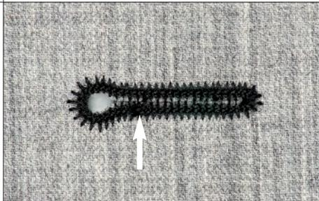
**581-112 E1151:** Augenknopfloch mit Rundriegel, bis max. 5 mm Breite; Schneidvorgang nach dem Nähen; ohne Gimpe; wählbarer Nähbeginn: Nähbeginn und Nähende liegen kurz unterhalb des Auges – der Rundriegel ist perfekt sauber; typische Anwendungen: Hinterhosentaschen und Ärmelschlitz.
