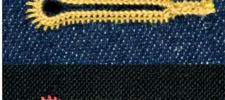
**581-121 E1201 / 581-151 E1501 / 581-321 E3201:** Augenknopfloch mit Keilriegel, bis max. 5 mm Breite; Schneidvorgang nach dem Nähen; mit unterer Gimpe; typische Anwendungen: Jeans und Sportswear.
