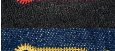
**581-141 E1423 / 581-341 E3421:** Augenknopfloch mit Keilriegel, von 5 bis 8 mm Breite; Schneidvorgang vor oder nach dem Nähen; mit unterer Gimpe; typische Anwendungen: Jeans und Sportswear.
